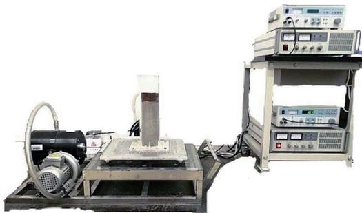
图3 双向水平振动氡析出实验装置实物图
