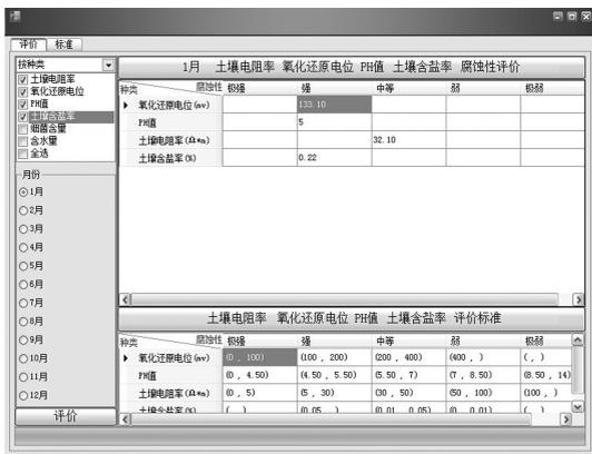
图6 某些土壤腐蚀因素在某个月的腐蚀性评价
